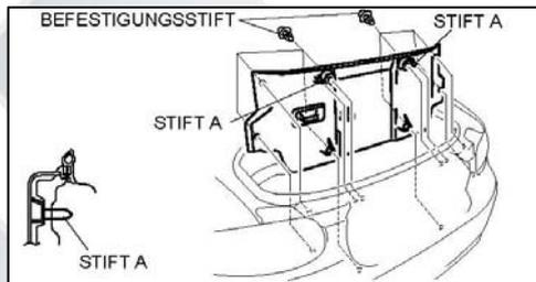
Die Befestigungsstifte der Trennwandverkleidung herausziehen. Die Verkleidung entfernen.
