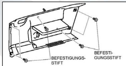
Die Befestigungsstifte der Seitenverkleidungen rechts/links herausziehen. Die Verkleidungen ausbauen.
