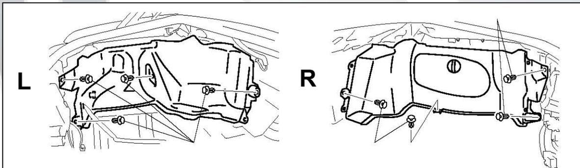
Jetzt können die freigewordenen Domschrauben gelöst werden. Lösen Sie zusätzlich die untere Mutter der Tankeinfüllstutzenhalterung und die Befestigungsclips der verlegten Kabel.
