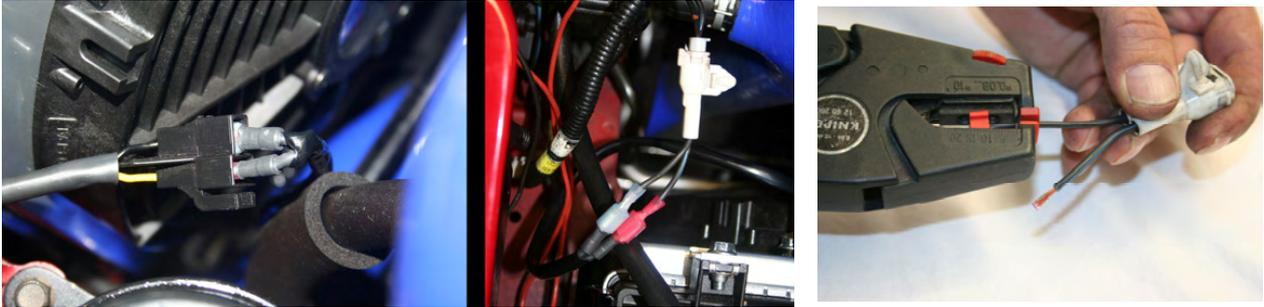
Wenn der zweite Lüfter auch als Kühllüfter verwendet werden soll, verbinden Sie die Lüfter mit dem im Lieferumfang enthaltenen Abzweigadapter.
